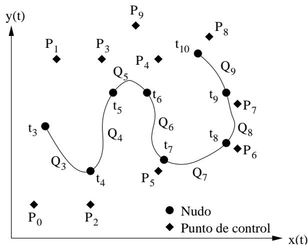
Figura 2: Un B-spline con segmentos de curva  $Q_3$  a  $Q_9$ . Esta figura fue hecha con el programa Xfig.
