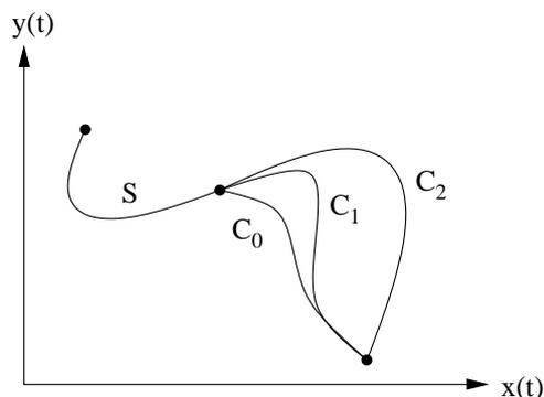
Figura 1: El segmento de curva S unido a los segmentos  $C_0$ ,  $C_1$  y  $C_2$  con los grados de *continuidad paramétrica* 0, 1 y 2, respectivamente. La distinción visual entre  $C_1$  y  $C_2$  es pequeña en el punto de unión pero muy obvia lejos del punto de unión
