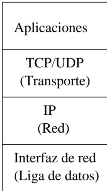
TCP, el Protocolo de Control de Transmisión, provee una entrega fiable del flujo y el servicio de conexión a las aplicaciones
